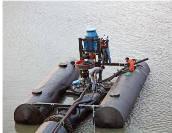
ra con una capacidad de bombeo de 9.000 m<sup>3</sup> de agua por hora, valuada por unos US\$ 268.944, y los equipamientos complementarios para su puesta en funcionamiento y así extraer agua cruda del río.
